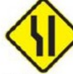
A-21d Alargamento de pista à esquerda
